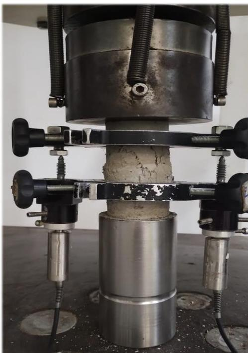
Foram seguidas as normas NBR 5739 (ABNT, 2018) e NBR 8522-1 (ABNT, 2021) para a determinação da resistência à compressão e do módulo de elasticidade, que é uma medida de rigidez do material.
