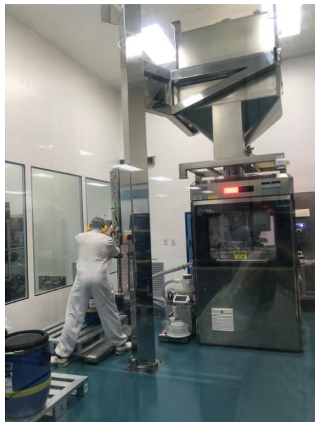
Figura 10: Colaborador operando a Compressora na sala de compressão da Fármacos do Brasil onde os pós misturados são transformados em comprimidos.
