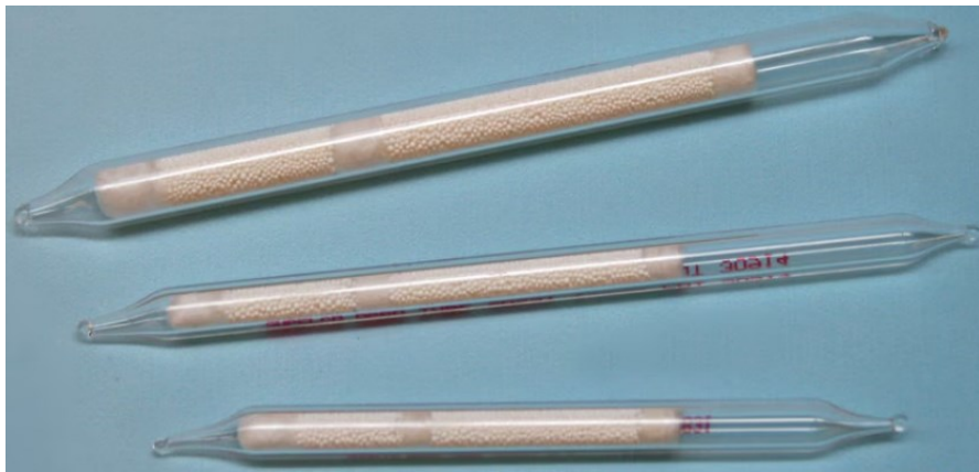
Figura 20 - Exemplo do cartucho adsorvente HPA usado na coleta do HPAs
