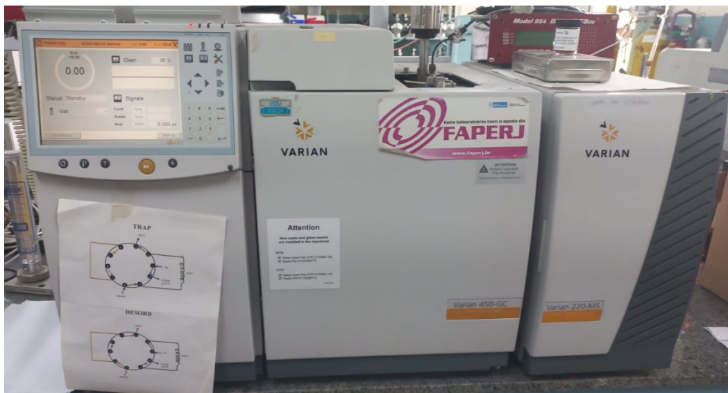
Figura 27 - Cromatógrafo a gás e espectrômetro de massas utilizado na análise das amostras de HPA e de BTEX
