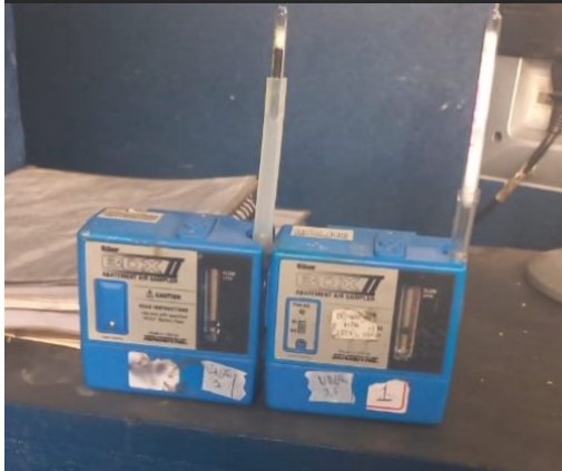
Figura 22 - Bombas de amostragem de BTEX e HPA -PONTO 1
