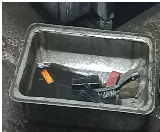
Figura 14 - Recipiente com a mistura de gasolina e diesel após algumas lavagens
