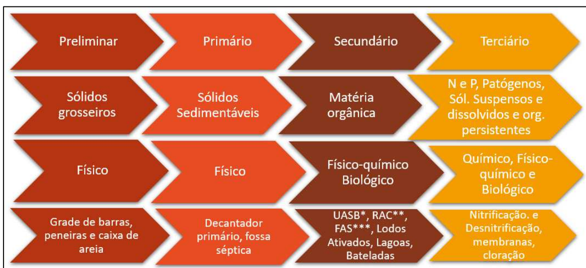
Figura 1: Exemplos de tecnologias de tratamento geralmente adotadas em ETE convencionais: etapas e processos de tratamento junto a objetivos de remoção
