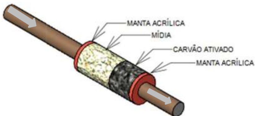
Figura 39 – Pré-filtros do sistema de tratamento
