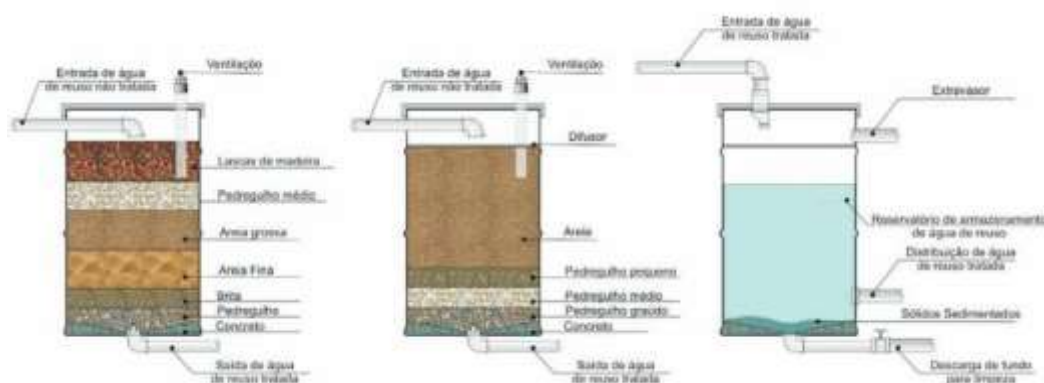
Figura 19 – Filtro de múltiplas camadas utilizado para tratamento de águas cinzas destinadas ao reúso
