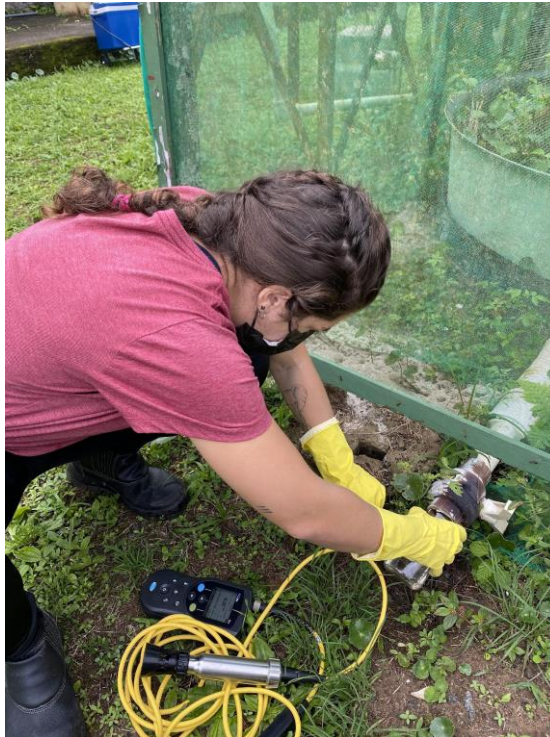
Figura 12 - Coleta e monitoramento do efluente final do Ecossistema Engenheirado
