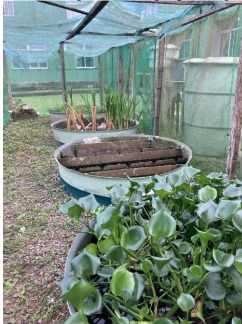
Figura 9 - O sistema alagado. De frente para trás: Aguapé - Algas - Typha - Gramíneas
