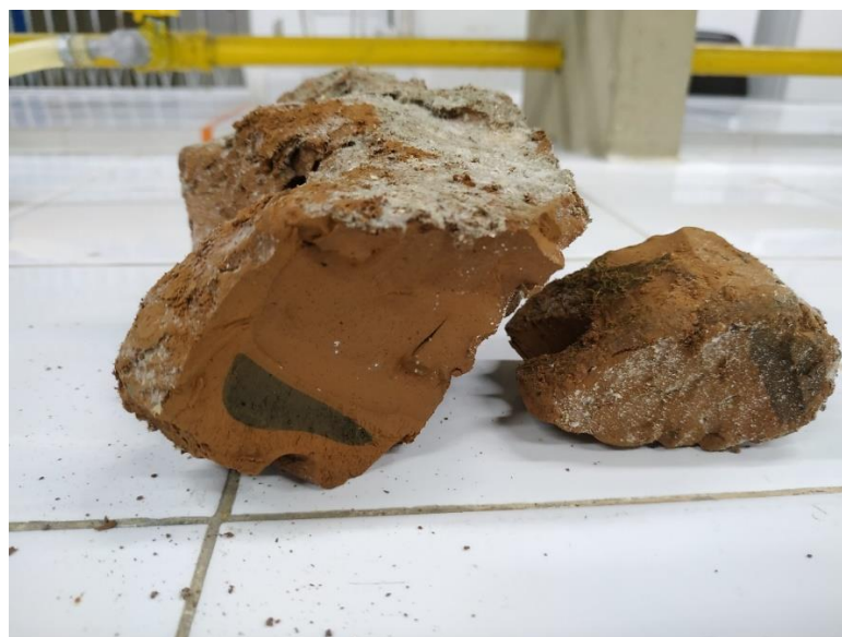
Figura 4 - Aspectos visuais do Lodo de Estação de Tratamento de Água da ETA da Universidade Federal de Viçosa, MG, Brasil. Lodo proveniente do sistema piloto de leito de drenagem e armazenado em saco de rafia.
