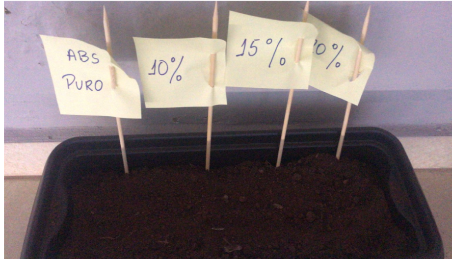
Figura 20. Metodologia do Teste de Biodegradação dos corpos de prova impressos em ABS puro, ABS10%Palmeira, ABS15%Palmeira e ABS20%Palmeira.
