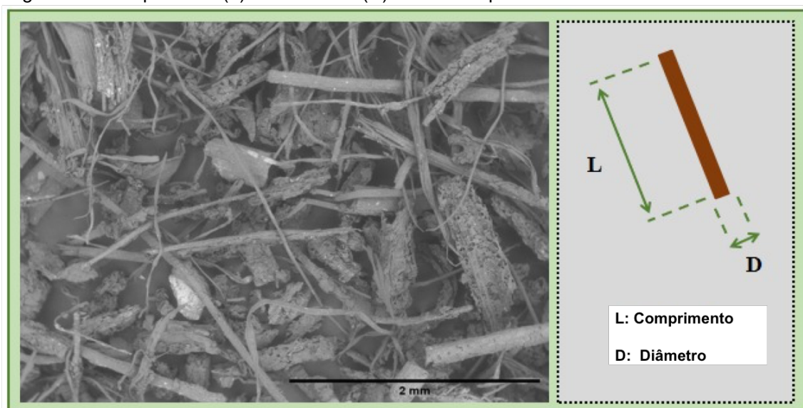
Figura 22. Comprimento (L) e o diâmetro (D) da fibra de palmeira.
