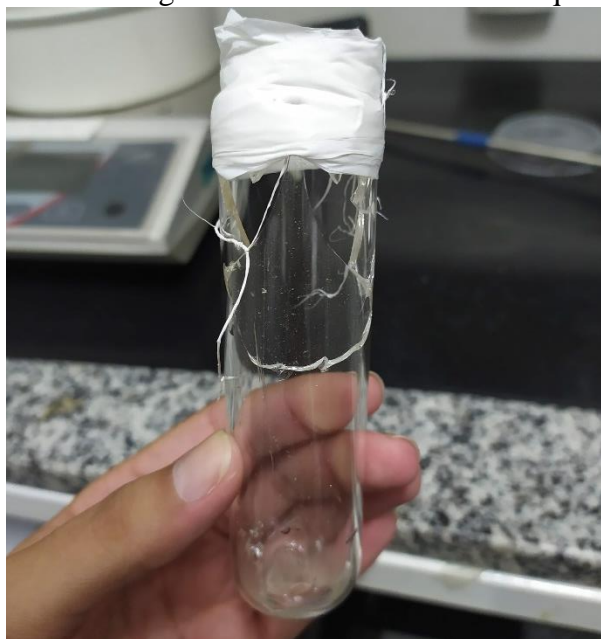
Figura 31 – Imagem do condensador de vidro quebrado
