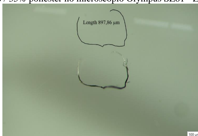
Figura 24 – Imagem de fibra de tecido encontrada em resíduo pirolisado do tecido 65% algodão / 35% poliéster no microscópio Olympus SZ61 - Zoom 40x
