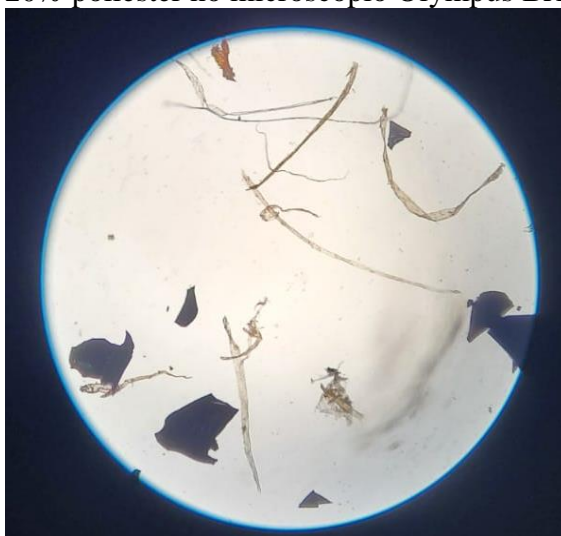
Figura 22 – Imagens das fibras de tecido encontradas no resíduo pirolisado do tecido 80% algodão / 20% poliéster no microscópio Olympus BX60 – Zoom 50x
