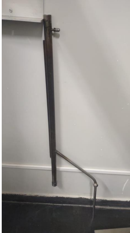
Figura 8 - Reator do forno com rampa de temperatura
