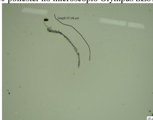
Figura 25 - Imagem de fibra de tecido encontrada em resíduo pirolisado do tecido 80% algodão / 20% poliéster no microscópio Olympus SZ61 - Zoom 180x
