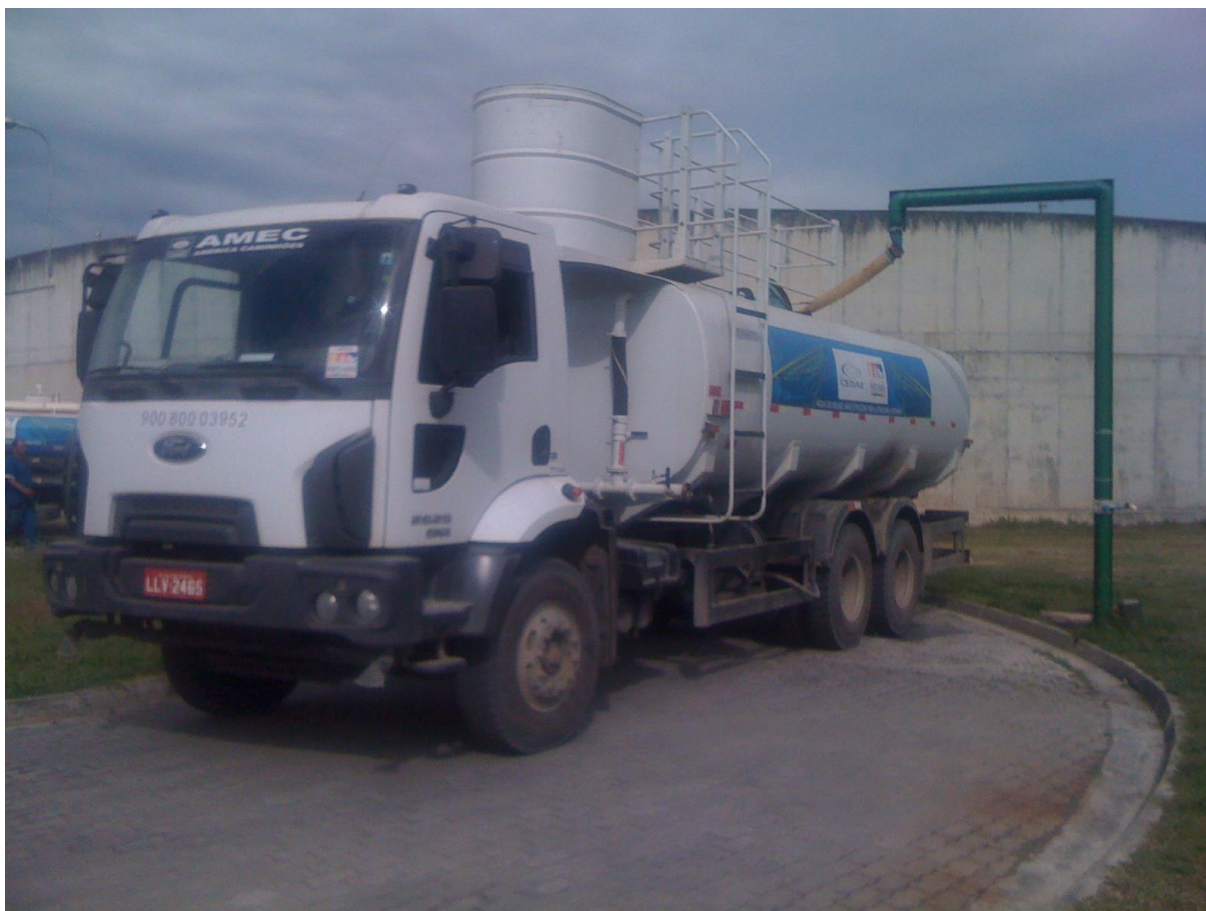
Figura 27 – Foto do carregamento de caminhão-pipa com água para reúso na ETE Alegria.
