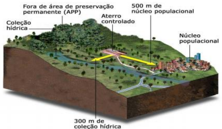
Figura 2 - Esquema de um aterro controlado. Fonte FEAM 2008.
