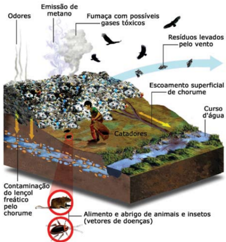
Figura 5 - Impactos causados por disposições inadequadas de resíduos sólidos
