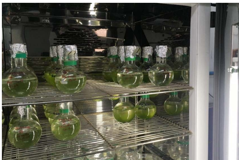
Figura 22: Microalgas C. vulgaris em incubadora a 25 \pm 2 °C com fotoperíodo 16h luz/8h escuro
