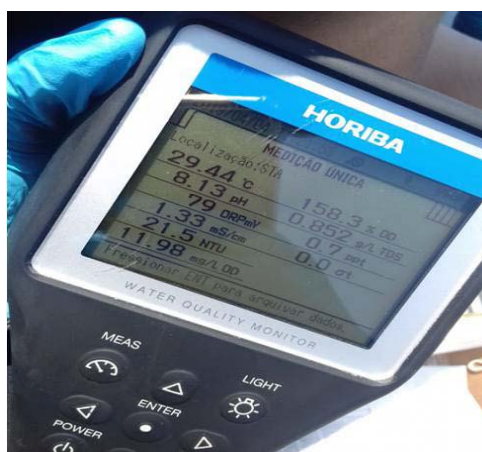
Figura 21: Sonda Multiparâmetro Horiba – modelo U-50 para análises físico-químicas.
