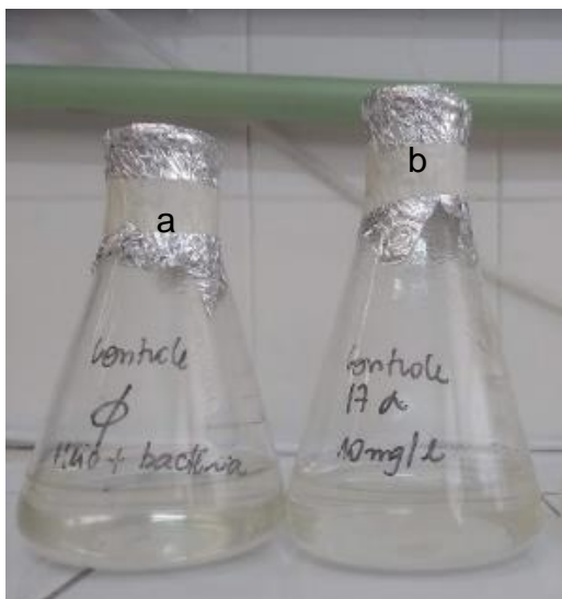
Figura 13: O controle MM: a) com bactéria sem hormônio (MM+cepa). b) com hormônio sem bactérias (MM+EE2 sem cepa). Fonte: o autor.
