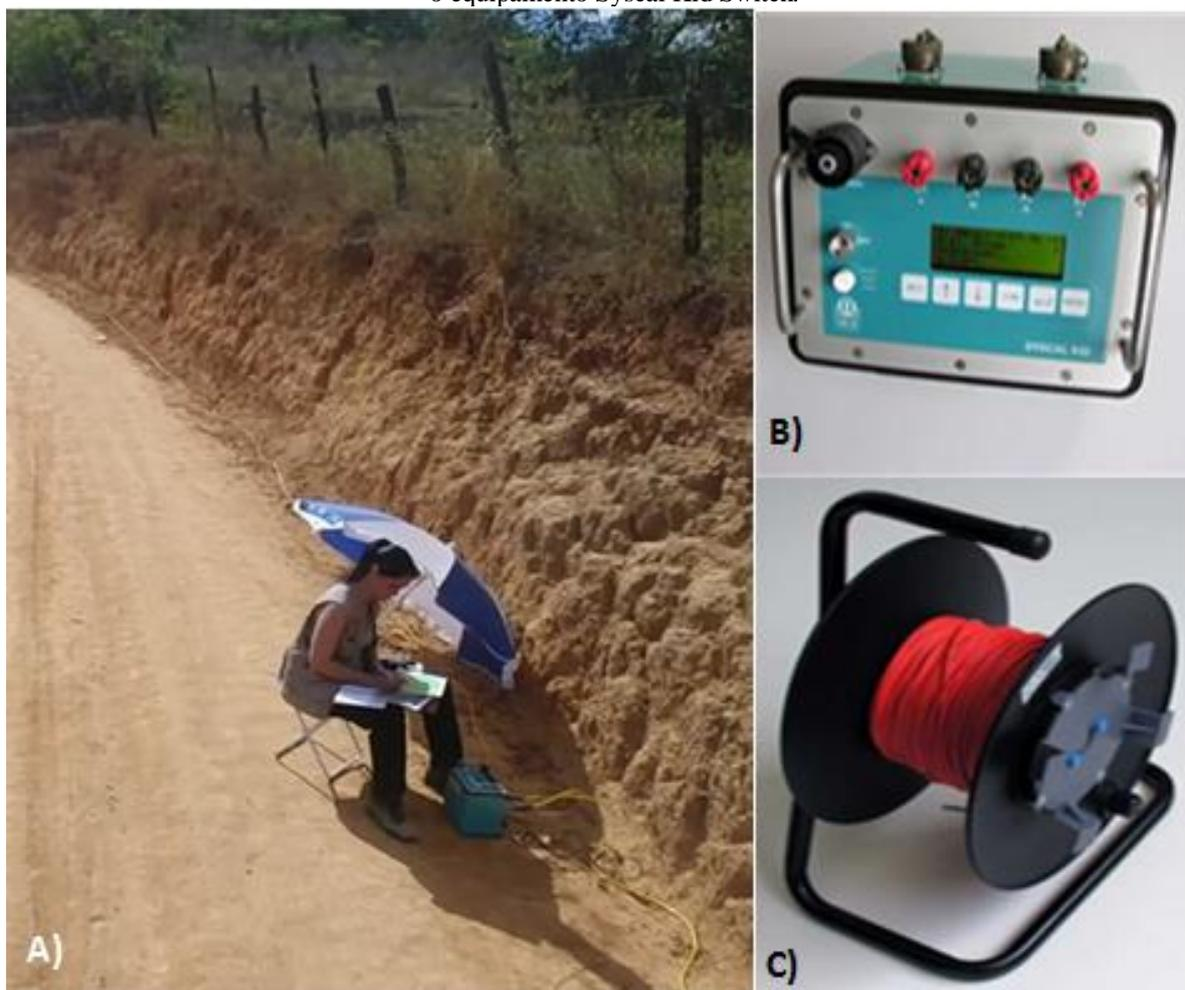
Legenda: A) Equipamento *Syscal Kid* em aquisição pelo método elétrico, por meio da técnica do caminhamento elétrico. B) Detalhe do módulo de aquisição do eletroresistivímetro *Syscal Kid*. C) Cabo de conexão entre o módulo e os eletrodos para a injeção de corrente em subsuperfície.
