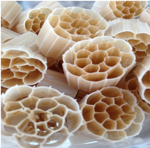
Figura 6 – Meio suporte da marca Enviromex utilizado para enchimento dos tanques do MBBR.
