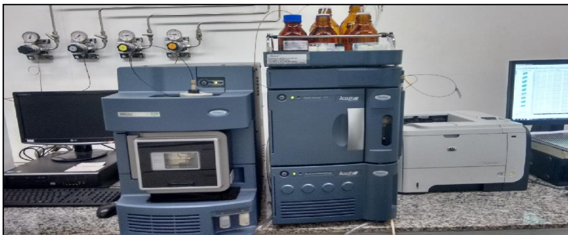
Figura 10- Cromatografia em fase líquida de ultra eficiência acoplada a espectrometria de massas XEVO TQD, Triplo Quadrupolo – Waters.
