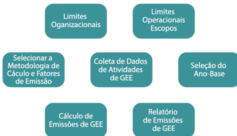
Figura 12: Etapas para a elaboração do inventário de emissões de gases de efeito estufa.
