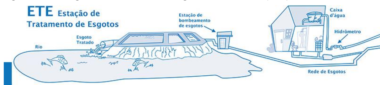
Figura 16 – Fluxograma de um sistema de esgotamento sanitário (ETE).
