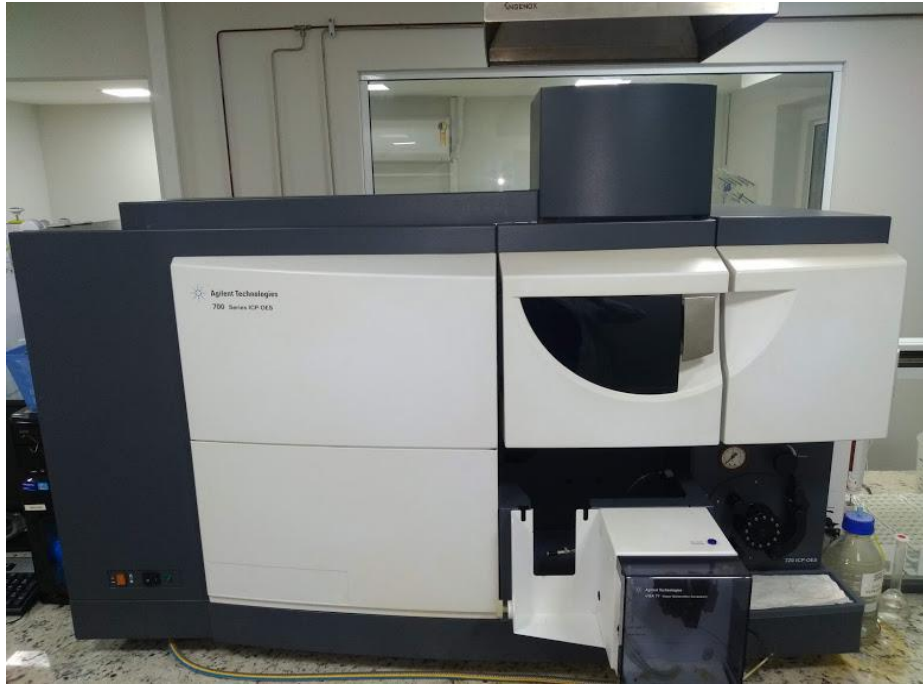
Figura 15 - Espectrômetro de Emissão Ótica por Plasma Indutivamente Acoplado – ICP – OES, AGILENT - Série 700
