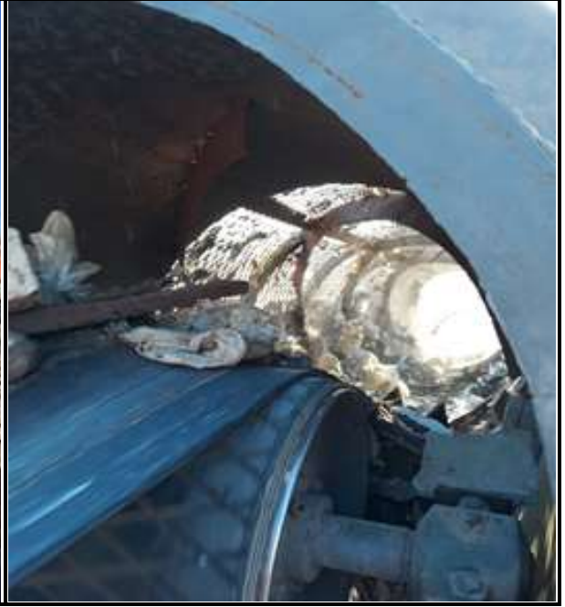
Figura 30 – Triagem no Trommel (Peneira Rotativa)
