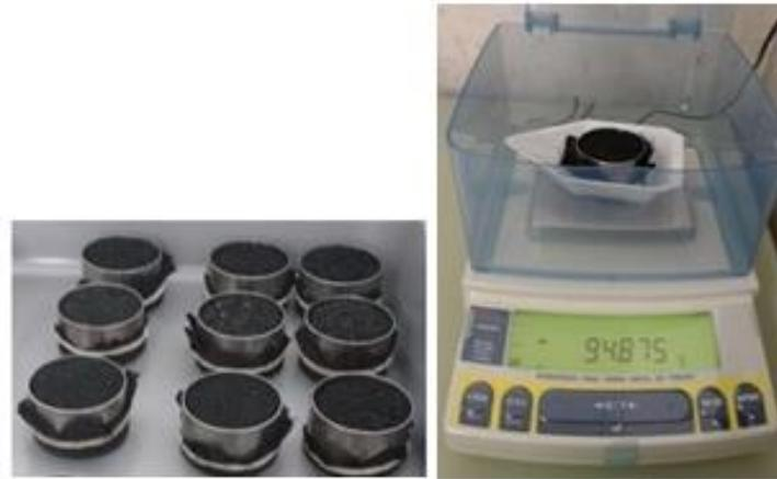
Figura 7 – Amostras em anéis de aço. (Acervo pessoal)
