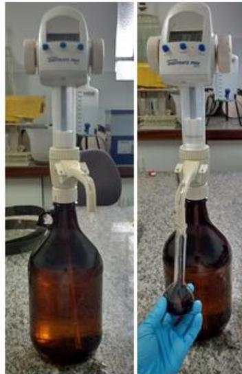
Figura 9 – Teste de densidade de partículas pelo método do balão volumétrico com titulação de álcool com bureta digital. (Acervo pessoal)
