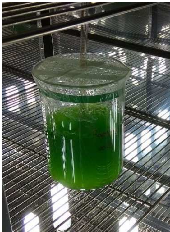
Figura 6 - Frasco Erlenmeyer de 2000 mL com a microalga Raphidocelis subcapitata e EtBr durante o ensaio em incubadora
