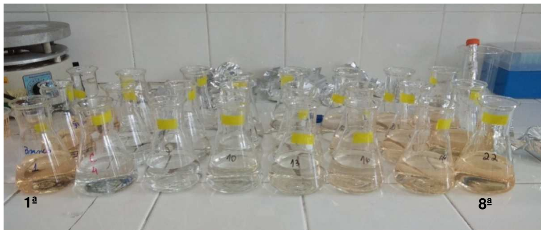
Figura 3 - Ensaio estático de ecotoxicidade crônica do Brometo de Etídio (EtBr) com a microalga da espécie D. subspicatus (n=3). Da esquerda para a direita: 1ª coluna - Controle EtBr; 2ª coluna - Controle negativo; 3ª-8ª coluna 0,25; 0,5; 1,0; 2,0; 4,0; 8,0 mg/L de EtBr
