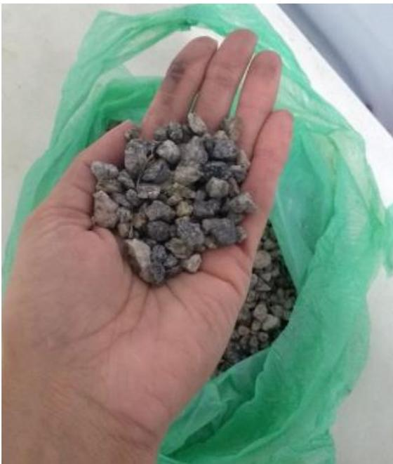
Figura 11 - Fotografia da areia utilizada no Filtro Simples e duplo
