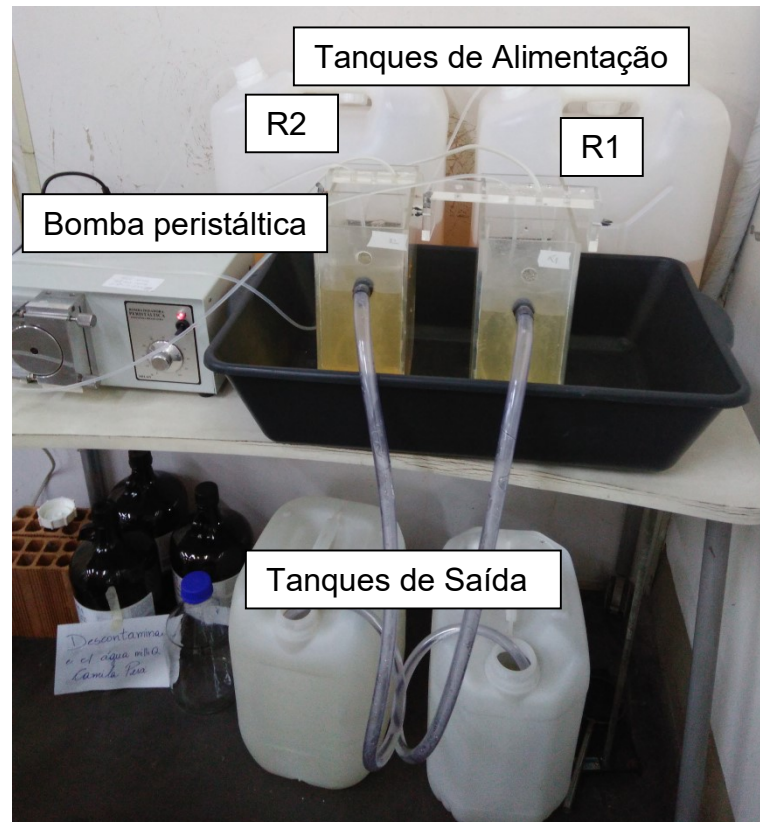
Figura 12 – Reatores de lodo ativado operados em modo contínuo em escala de bancada – fase 2.
