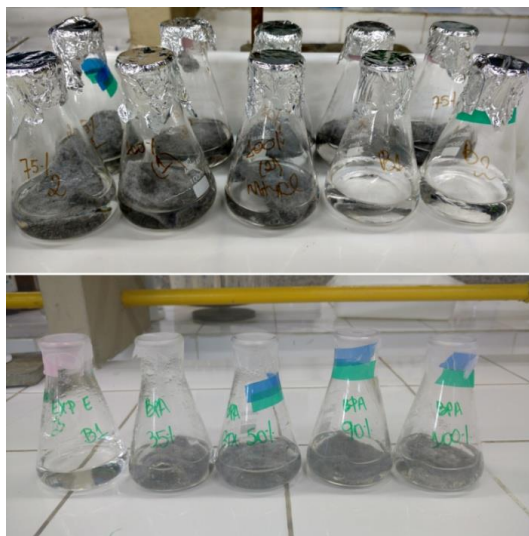
Figura 17 – Ensaio de equilíbrio em lote com geotêxtil (Acervo pessoal)
