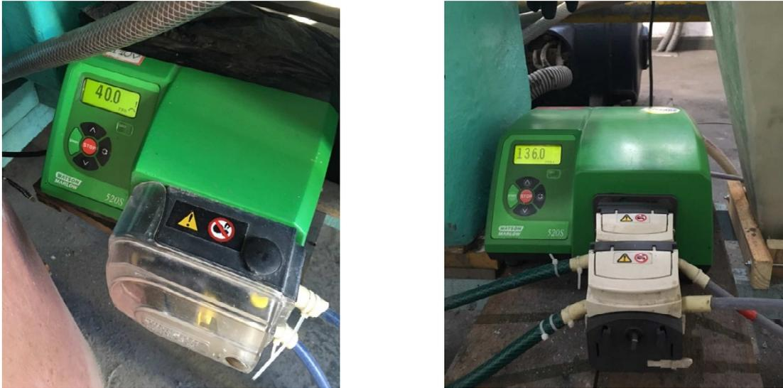
Legenda: (a) bomba marca Watson-Marlow utilizada para alimentação do sistema e (b) bomba marca Watson-Marlow utilizada para recirculação.
