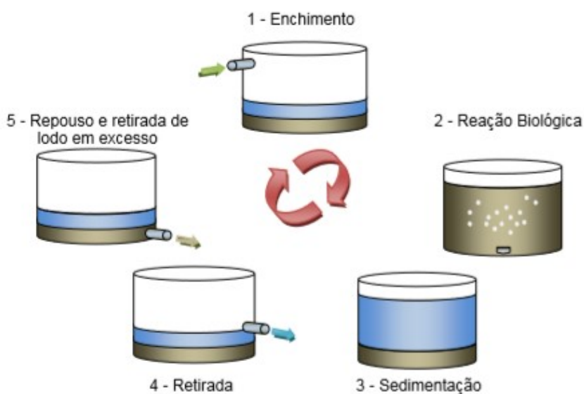
Figura 7 - Etapas de operação de um sistema SBR.
