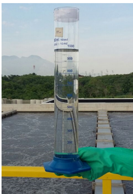
Figura 27 – Efluente tratado na ETE Deodoro a ser descartado no corpo hídrico.
