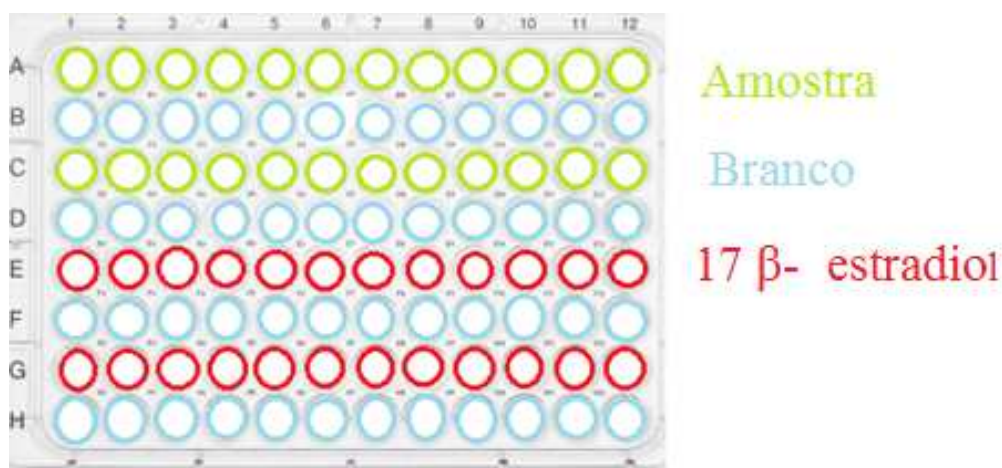
Figura 12: Ilustração da placa de análise com amostra, branco e controle positivo (17 \beta -estradiol)
