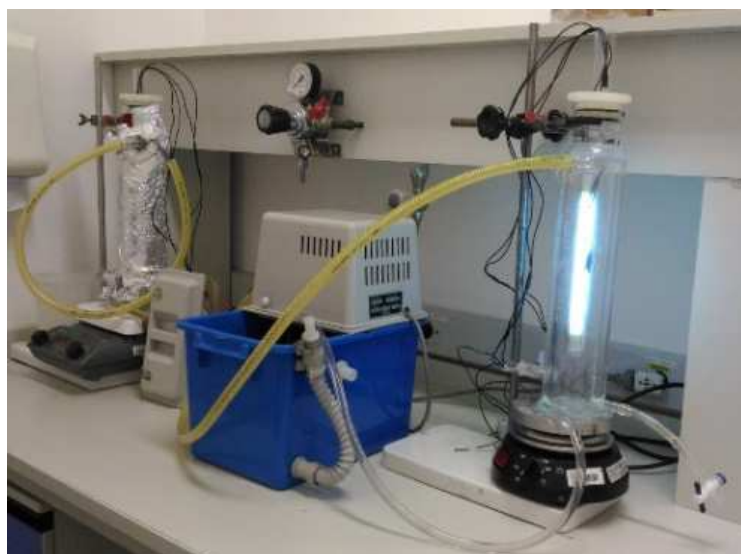
Figura 8: Sistema reacional utilizado nos experimentos fotólise e fotodegradação \text{Cl}/\text{UV} e \text{H}_2\text{O}_2/\text{UV}
