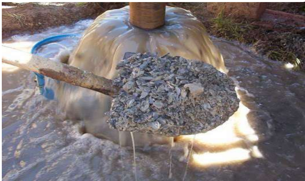
Figura 11 – Exemplo de cascalho proveniente da perfuração de poços de petróleo e gás natural
