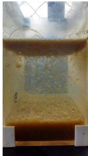
**Figura 5.22** – Amostras tratadas da fase sobrenadante (Fe e Al, e DQO) e do efluente tratado e homogeneizado (análises de sólidos totais, sólidos voláteis e umidade)
