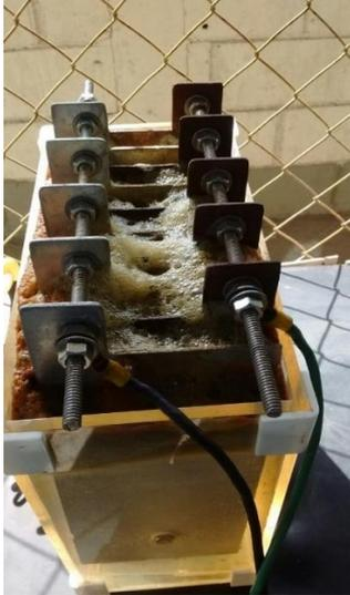
**Figura 5.18** – Vista lateral do reator eletrolítico com efluente tratado
