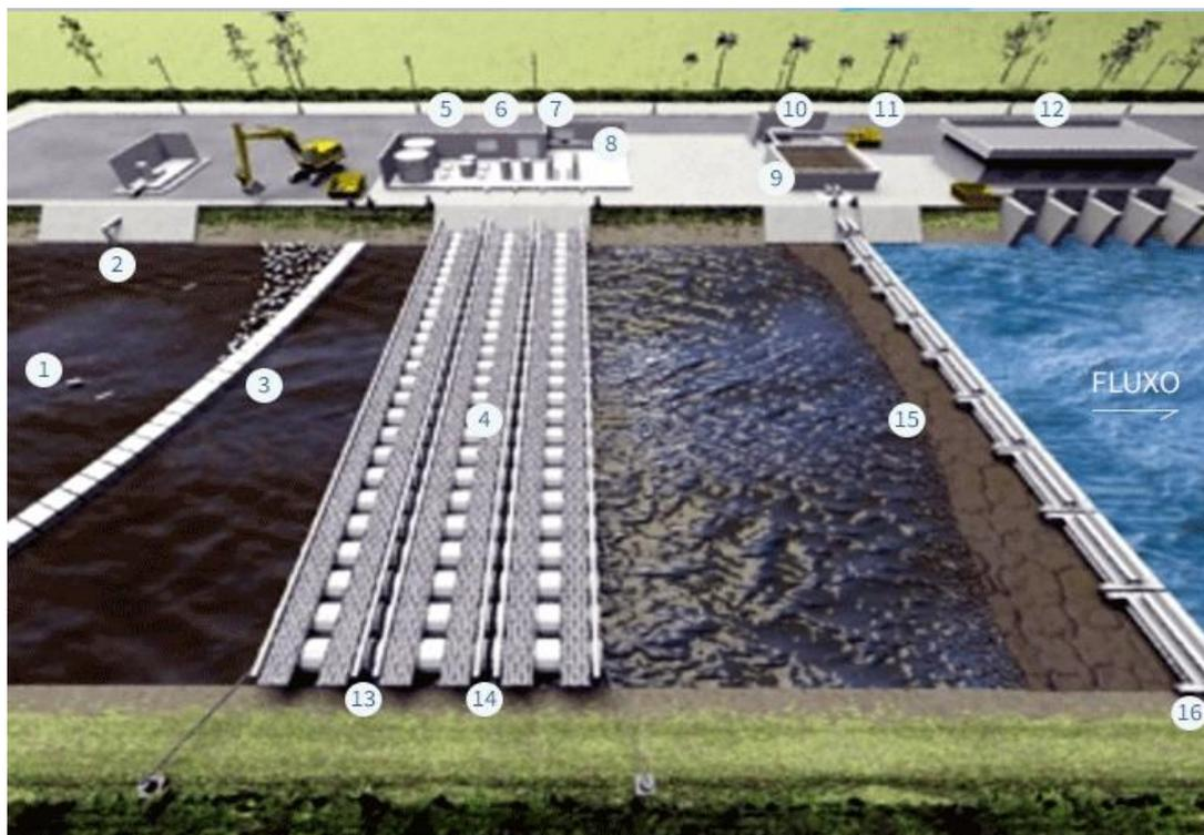
Legenda: (1) Caixa de areia; (2) Difusores de ar; (3) Cerca flutuante; (4) Plataforma flutuante; (5) Tanque de coagulante/polímero (6) Sopradores de ar; (7) Misturadores água/ar; (8) Laboratórios; (9) Tanques de lodo; (10) Centrífugas para desidratação e estabilização de lodo; (11) Caçambas de lixo; (12) Casa de bombas; (13) Injeção de coagulante/ polímero; (14) Difusores de ar; (15) Lodo flotado; (16) Rodas de dragagem de lodo.
