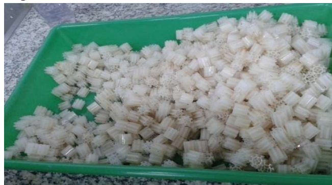
Figura 16 – Recheio retirado do interior do filtro
