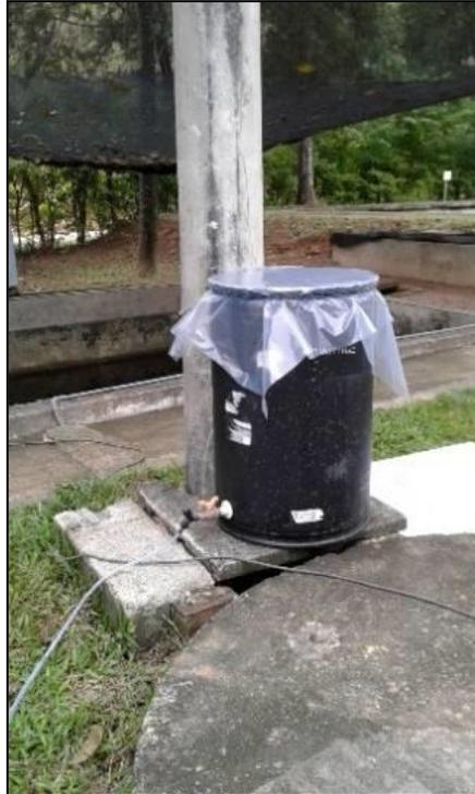
A marca do nível de 100 litros no tonel foi feita por cubagem (enchimento de 10 litros de água através de proveta graduada num balde menor, colocação dessa medida 10 vezes no tonel com o balde cubado), o nível encontrado foi marcado com tinta. O fósforo posteriormente introduzido era diluído, o que restava do volume morto era esvaziado, portanto não interferia na concentração de fósforo do afluente do próximo enchimento do tonel.
