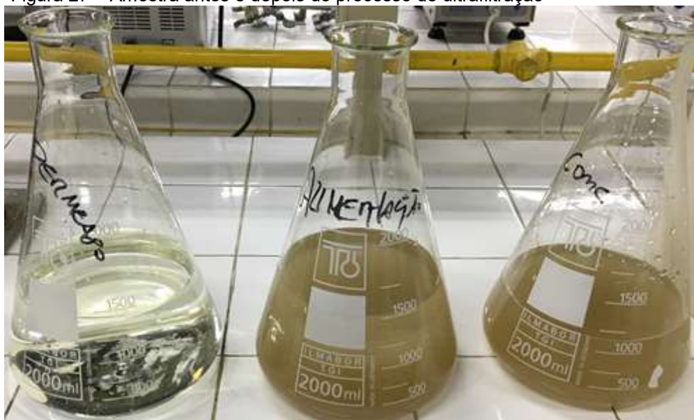
Figura 27 – Amostra antes e depois do processo de ultrafiltração
