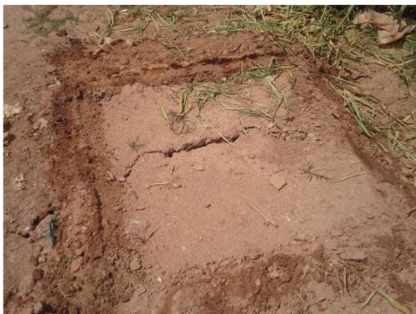
Os demais ensaios (C1, C5 e C6) na camada de cobertura convencional com solo “A” foram realizados sobre rachaduras superficiais similares ao do ensaio C4 (Figura 50-b) e, as emissões de  $\text{CH}_4$  apresentadas nessas investigações variaram de  $8,2 \text{ g/m}^2\cdot\text{dia}$  a  $14,7 \text{ g/m}^2\cdot\text{dia}$ .
