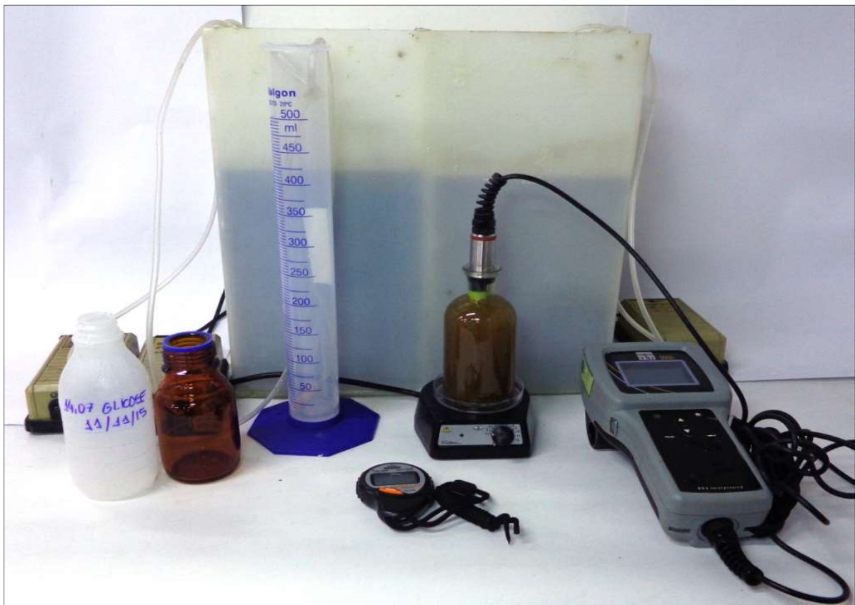
Figura 2.6 Foto dos materiais e equipamentos utilizados durante os testes de respirometria.
