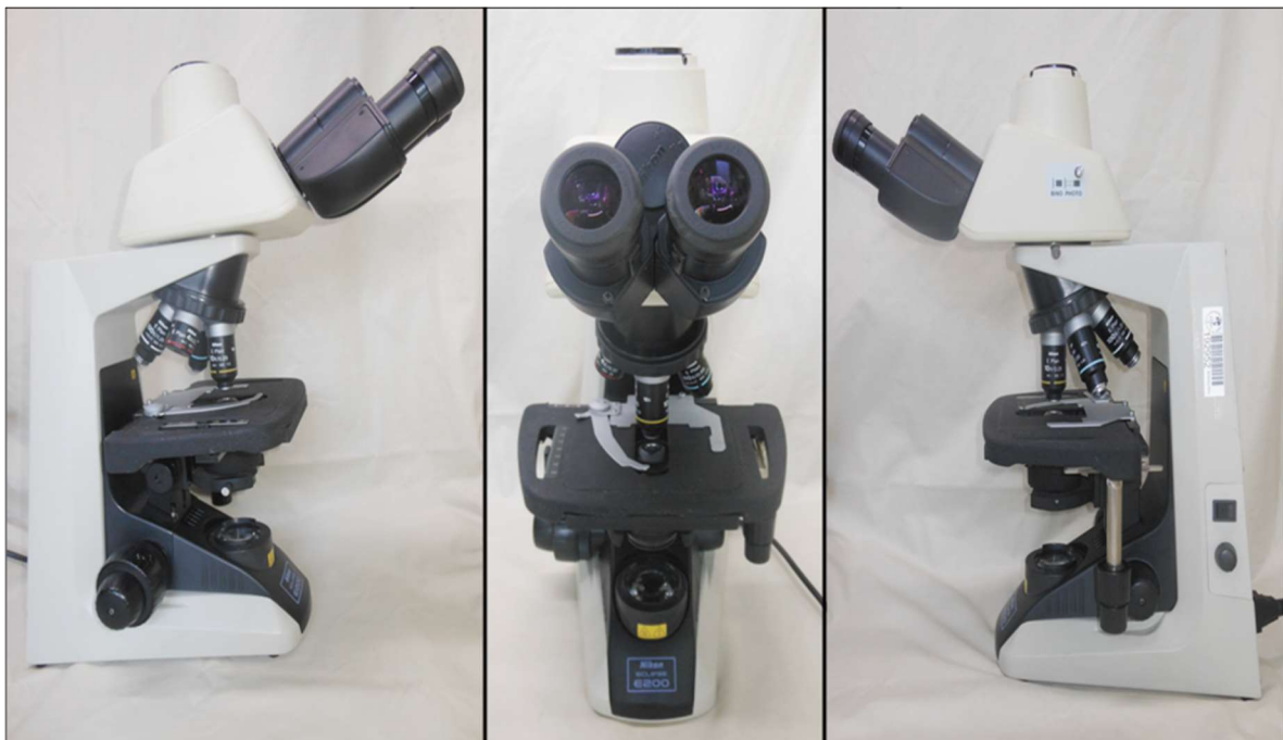
Figura 2.7 Microscópio óptico utilizado para a observação qualitativa do lodo.
