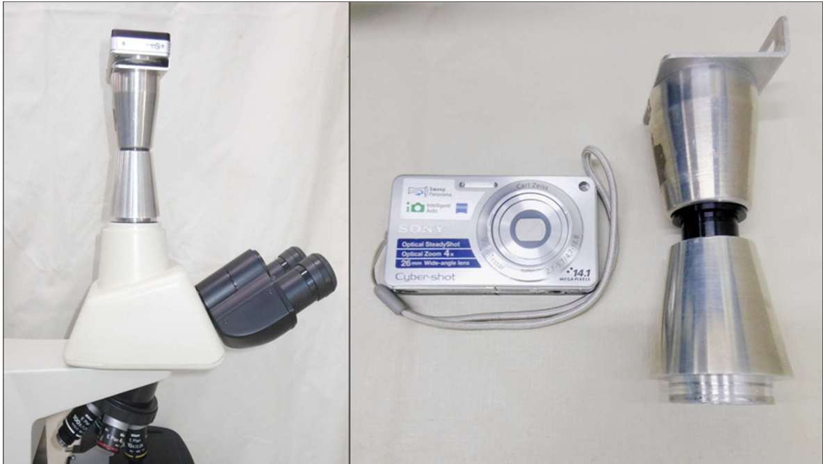
Figura 2.8 Câmera acoplada ao microscópio (à esquerda) Câmera digital Sony Cyber-shot (DSC-W350) e suporte de apoio (à direita).
