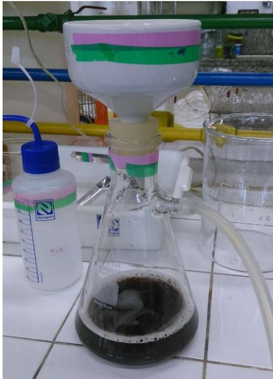
**Figura 22:** Foto do papel de filtro e membranas utilizadas no processo de filtração das amostras de lixiviados de RSU.
