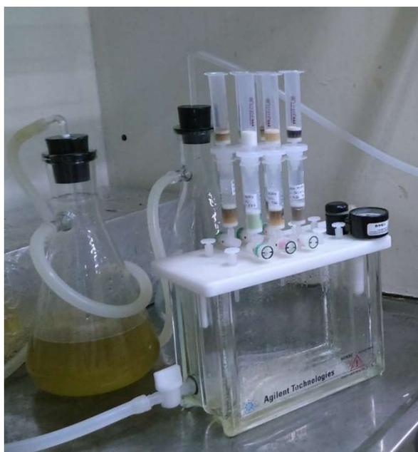
**Figura 24:** Foto das membranas utilizadas na filtração de amostras brutas após acidificação com ácido clorídrico.
