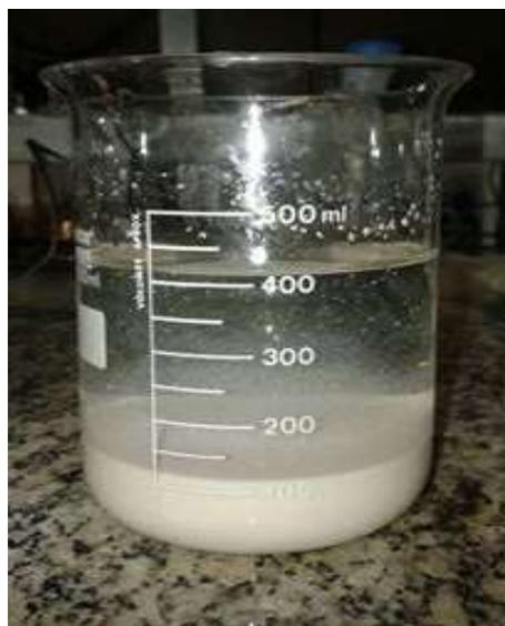
Inicialmente, as amostras foram acidificadas até pH1. Dessa forma, os ácidos húmicos presentes na amostra foram precipitados e separados por centrifugação (5 rpm durante 5 minutos). Em seguida, a amostra foi filtrada em filtro de acetato de celulose de  $0,45\mu\text{m}$ , e, o que ficou retido no filtro (parte sólida) é denominada de fração de ácidos húmicos (AH), que posteriormente foi solubilizada com NaOH 0,05 mol/L.
