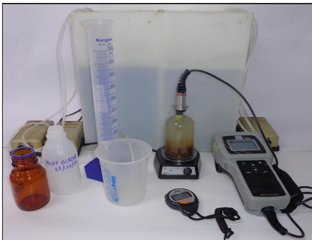
Figura 2.7 – Equipamentos e aparatos utilizados na realização dos testes de respirometria
