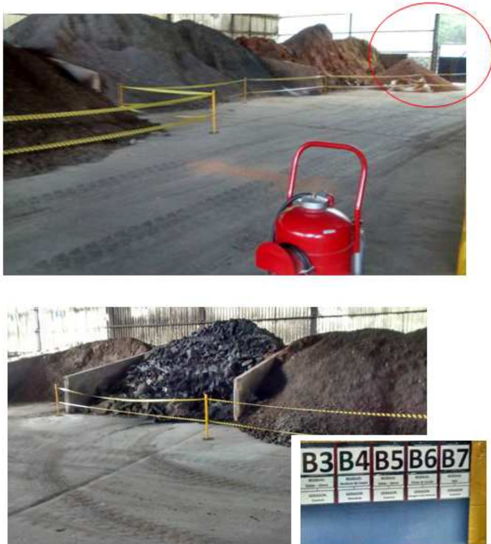
Figura 7 – Galpão de armazenamento do blend sólido com abertura na lateral e simbologia genérica
