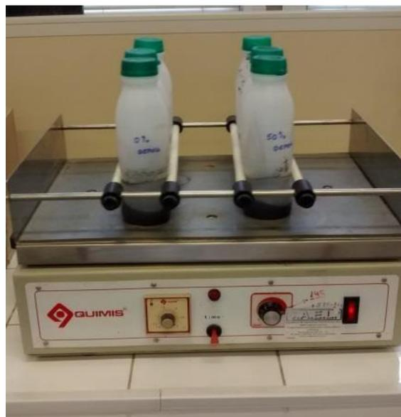
Finalizada a agitação foram determinados o pH e a condutividade elétrica das soluções antes de serem filtradas. As soluções foram filtradas, o lodo que permaneceu no papel de filtro foi descartado, e o filtrado foi analisado para os parâmetros DQO e COD.
