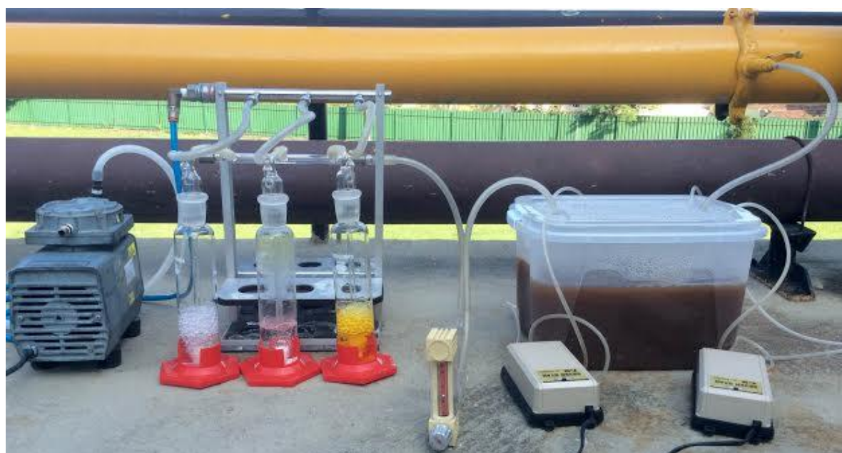
Figura 2.9 - Absorção da matéria orgânica dos gases captados na saída do biorreator aeróbio.
