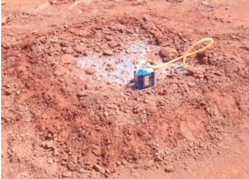
Nas coletas de BTEX no ar atmosférico foram utilizadas bombas BDX II, porém para estas, a calibração da vazão foi feita com um valor de  $1 \text{ L min}^{-1}$ . Em campo, tal bomba era acoplada ao cartucho de carvão ativado e ambos apoiados sobre um conjunto tripé + base metálica, os quais possibilitavam que o cartucho estivesse a um metro de altura do solo.
