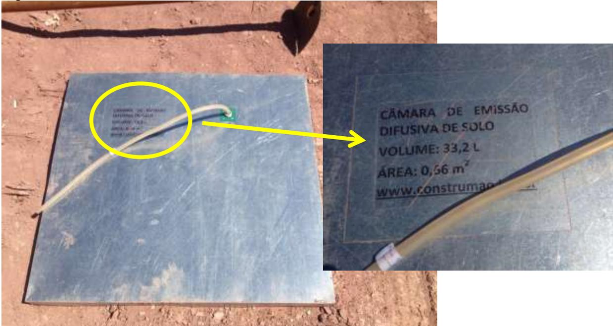
Figura 28 – Câmara de fluxo de 1 m<sup>2</sup> de área e 50 L de volume.
