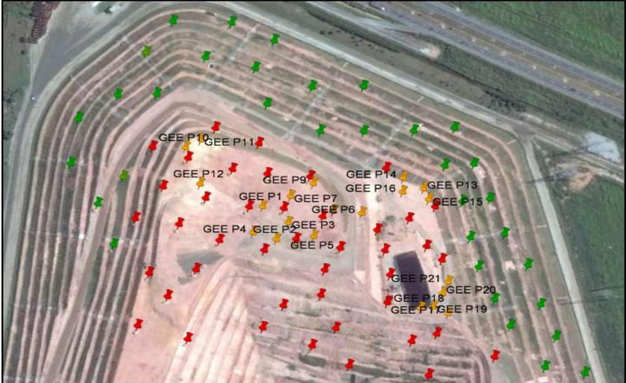
Figura 26 – Posicionamento dos pontos de coleta de BTEX de cor preta, na camada de cobertura.
