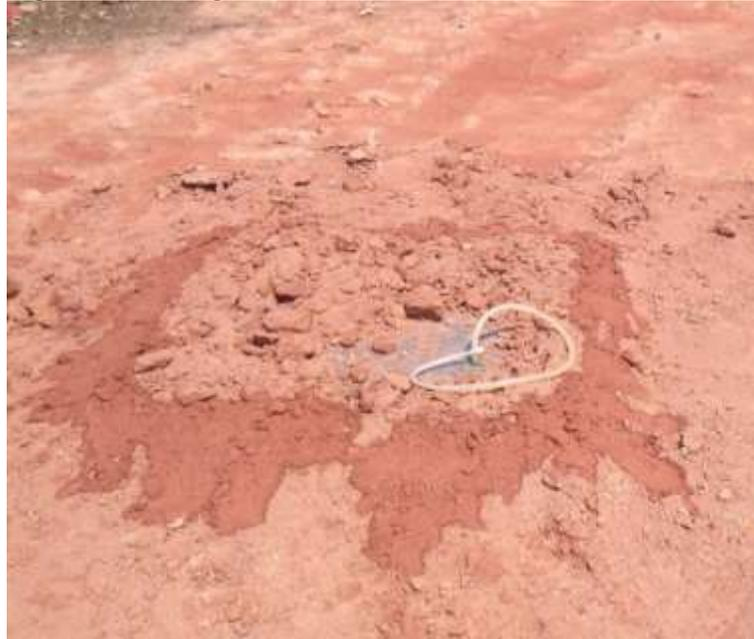
O fluxograma da Figura 36, apresenta as etapas de coleta dos GEE na camada de cobertura, utilizando a placa de fluxo e seringas de plásticos, em diferentes tempos de coleta, para o cálculo das taxas de emissão destes gases.
