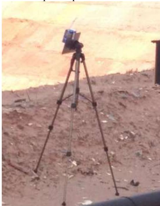
Além da coleta e amostragem de gases, também foram coletadas informações de temperatura, teor de umidade, pressão e intensidade do vento durante os dias de amostragem. O equipamento utilizado para isto foi o termo-higro-anemometro-luxímetro digital portátil, modelo Thal-300, apresentado na Figura 34.
