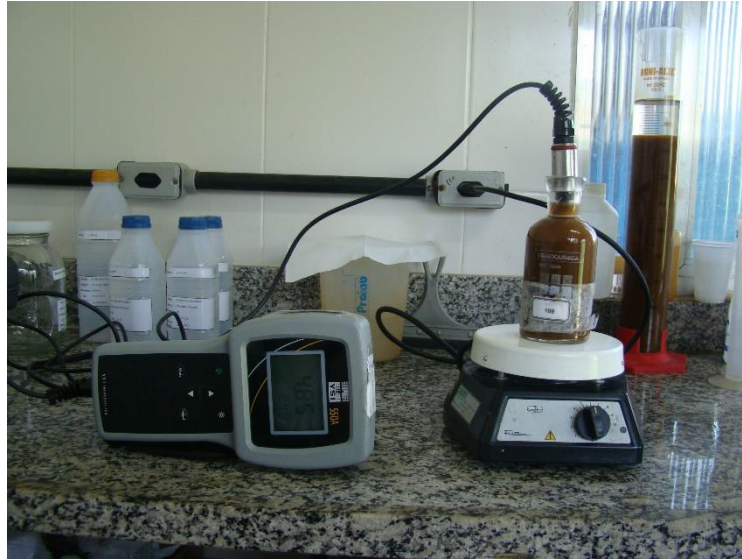
Figura 8 – Aparato para o Teste de Respirometria.
