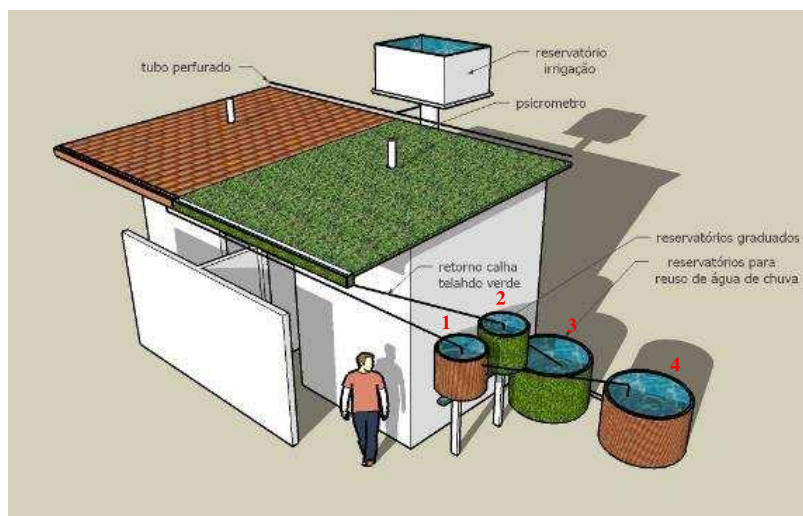
Figura 19 - Desenho experimental de telhados verdes na Escola Teófilo. Projeto HIDROCIDADES.
