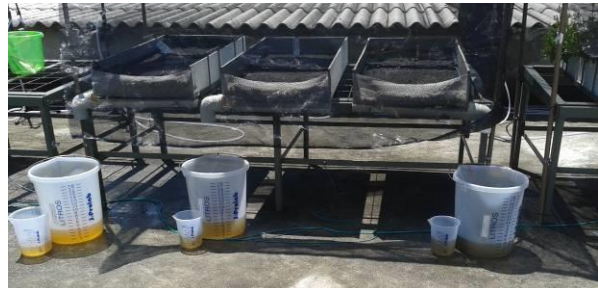
Figura 54 – Módulos experimentais sem vegetação. Da esquerda para a direita, módulos Flat 17L (F-17); Sistema Modular 4L (M-4) e Sistema Modular 17L (M-17). Ensaio de 29 jan 2015.
