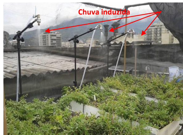
Figura 56 – Funcionamento dos bicos no ensaio de 155 mm/h sobre módulos vegetados. 23 jan. 2015.
