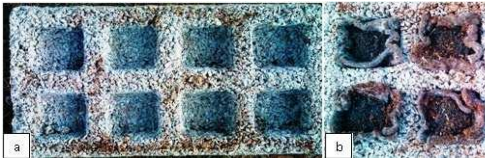
Figura 7 - Sistema modular para telhados verdes a base de resíduos de couro “a”. Com meio de suporte para vegetação envolto em feltro “b”.
