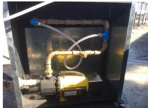
Figura 42 – Foto da unidade bombeadora do simulador de chuva (interna).
