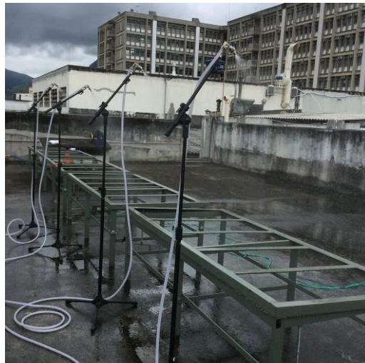
Figura 46 – Foto dos suportes de fixação dos bicos de jato (período de testes).
