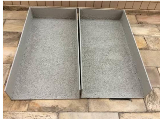
Figura 32 – Caixa para Unidade Experimental com as 2 demãos de impermeabilizante.
