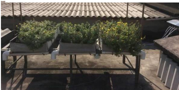
Figura 53 – Módulos experimentais vegetados. Da esquerda para a direita, módulos Flat 17L (F-17); Sistema Modular 4L (M-4) e Sistema Modular 17L (M-17), em 24 jan. 2015.
