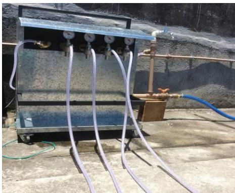
Figura 41 – Foto da unidade bombeadora do simulador de chuva (frontal).
