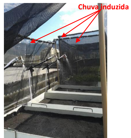
Figura 58 - Funcionamento dos bicos de jato sobre módulos não vegetados. Ensaio 28 jan 2015
