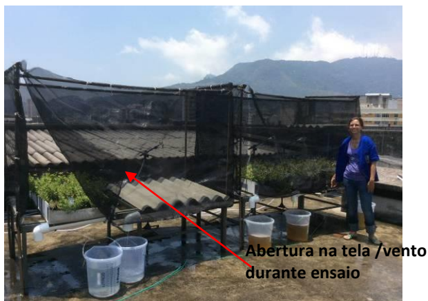
Figura 57 – Aguardando o término do runoff para quantificação do volume . Vento durante o ensaio 23 jan. 2015
