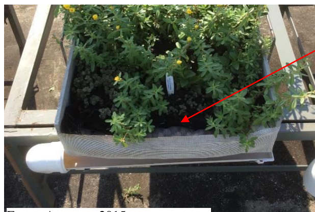
Figura 33 – Sistema de captação do runoff dos módulos com calha de PVC, saco de argila expandida e tela de fechamento.
