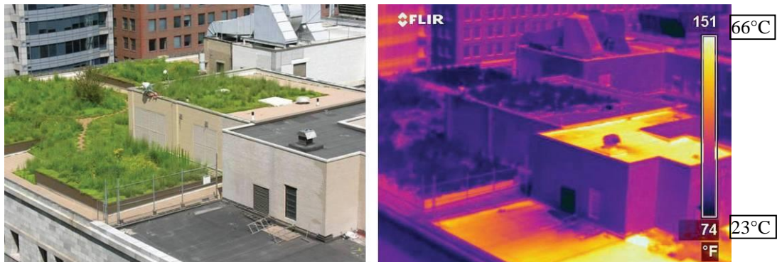
Figura 11- Diferença de temperatura entre telhado convencional e telhado vegetado em um dia típico na cidade de Chicago.
