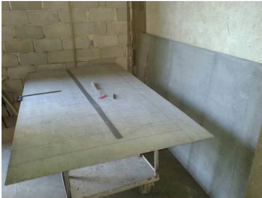
Figura 27 - Placa cimentícia, 8mm de espessura, fabricação Brasilit.
