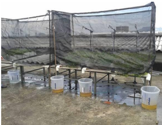
Figura 55 – Foto de ensaio de 155 mm/h nos módulos vegetados, em 23 jan. 2015.
