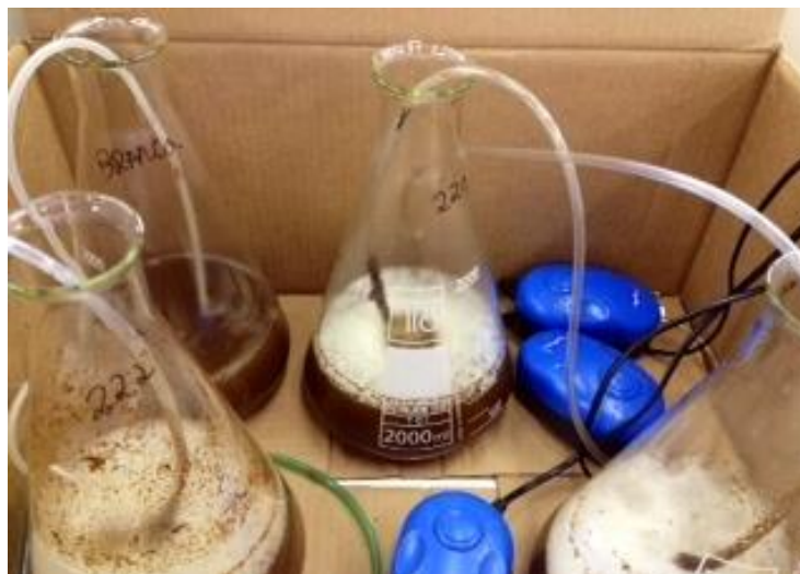
Figura 8 - Reatores biológicos e aeradores utilizados nos ensaios de biodegradabilidade aeróbica.
