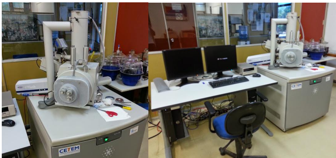
Figura 17 - Microscópio eletrônico de Varredura FEI Quanta 400 FEG (CETEM)
