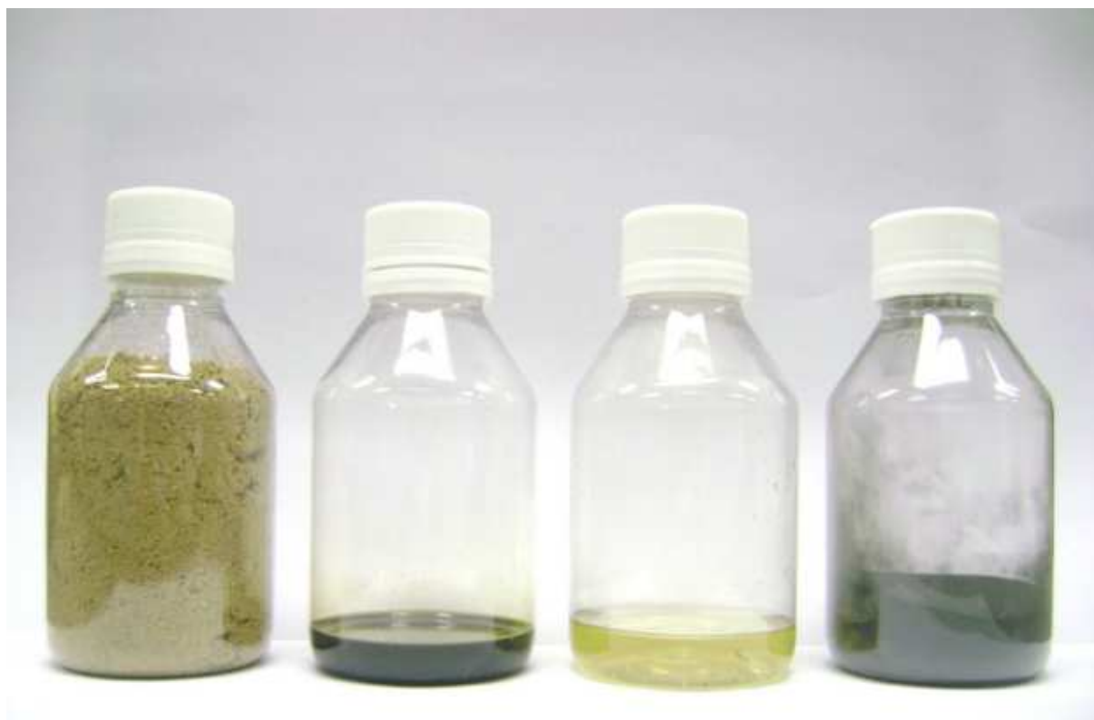
FIGURA 19 Teste TELAB 100, da esquerda para a direita: Amostras de resíduos de terra diatomácea (RTD), óleo recuperado (OR), água de reação (AR) e sólido recuperado (SR) (ALBRECHT, 2012)
