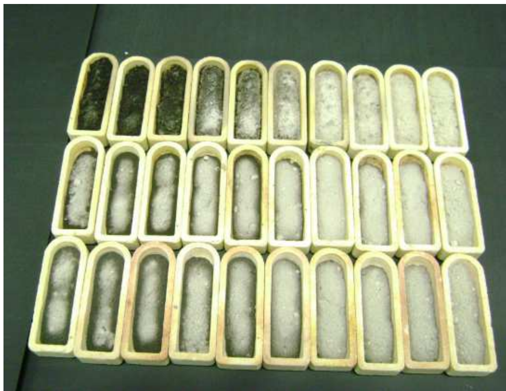
FIGURA 21 SR T103 calcinados a 440°C até 10 minutos (Obs: de cima para baixo: SR 1ª Passagem, SR 2ª Passagem e SR 3ª Passagem; da esquerda para a direita do primeiro ao décimo minuto) (ALBRECHT, 2012)
