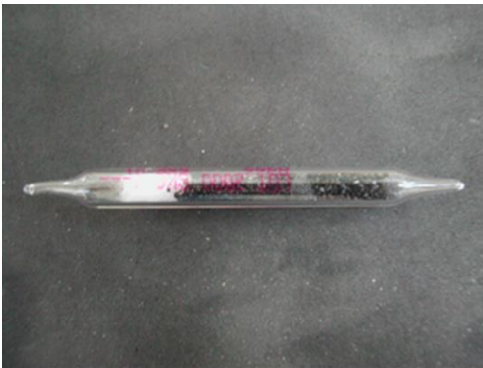
Figura 7-Cartucho de carvão ativo com leito principal de 100mg e leito de segurança de 50mg utilizado na coleta dos BTEX.
