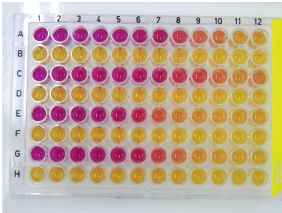
Figura 27 - Foto da placa de 96 poços no ensaio YES: linhas A e C contendo metilparabeno a 3,2 \text{ gL}^{-1} e linhas E e G contendo propilparabeno a 0,2 \text{ gL}^{-1} .
